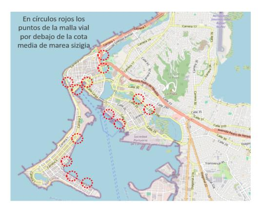
En términos de ingeniería hidráulica las soluciones involucran sistemas de infraestructura que pueden ser, tanque de almacenamiento, estaciones de bombeo, exclusas manuales o mecánicas y renivelación de pavimentos.
