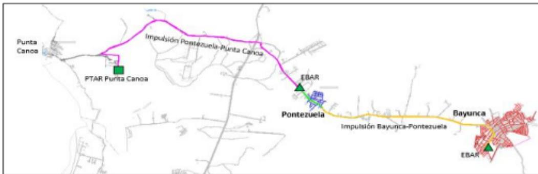
**Ilustración: Esquema General Sistema de Alcantarillado Bayunca y Pontezuela**
